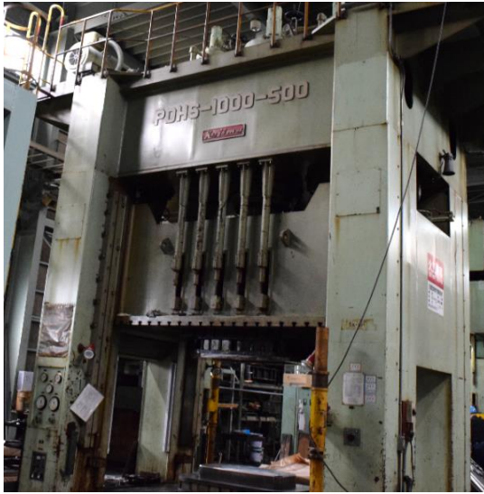
▲上下複動式油圧プレス機（1000t） この機械では、キッチンシンク等が作られている。
