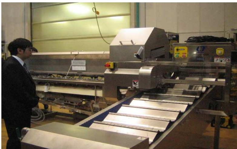
写真 サケの自動加工・処理ロボット
